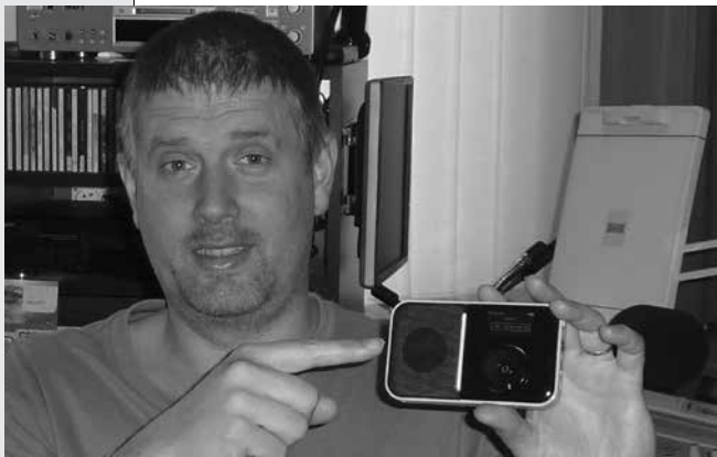
Zajímavý přijímač internetových rádií – přenosný, s vestavěnou dobíjecí baterií, přijímá bezdrátově, včetně příjmu VKV stanic.
